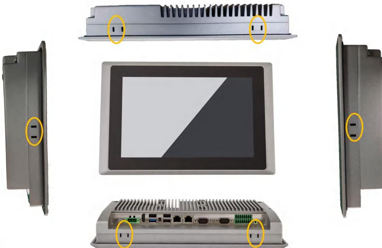
VESA75 安装，在机器的背面，设计了一个标准 VESA75 的安装孔位，采用此种方式安装时需要准备一个 VESA75 的支架
